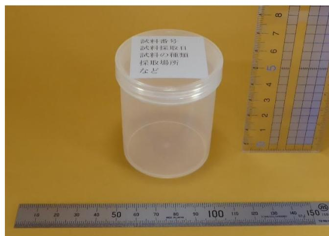
図 B.4 測定試料容器の準備例
