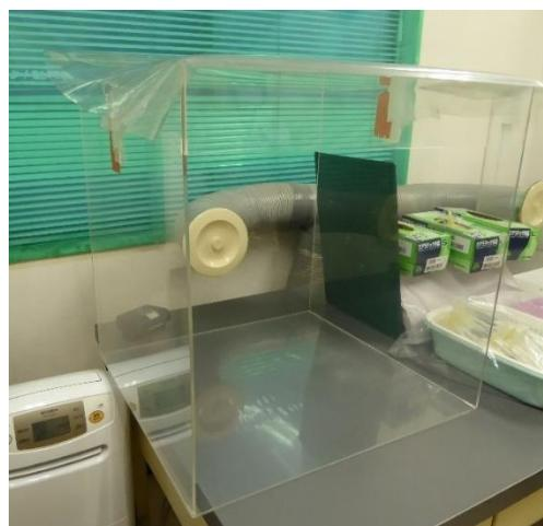
図 B. 5 試料充填用簡易ドラフトボックスの例
