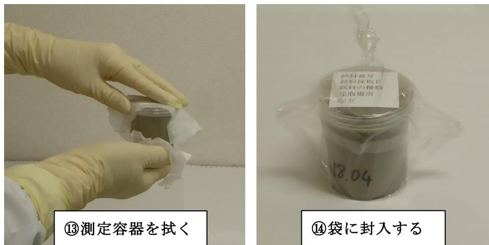
図 B. 6. 6 試料充填手順(6)
