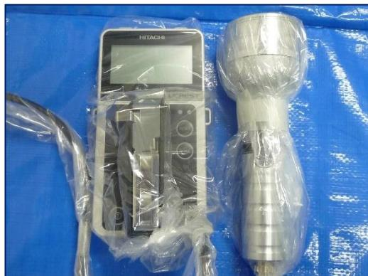
【GM管式サーベイメータの養生の例】
