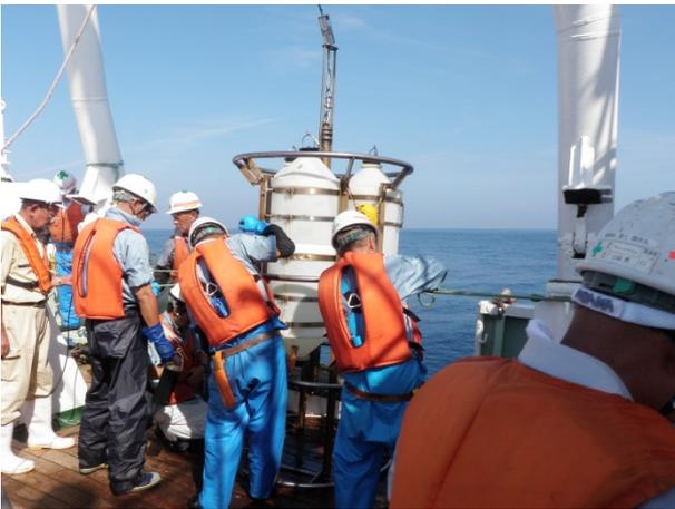
大型採水器による採水作業
